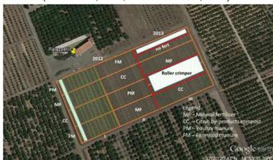
Fig. 1 – Palap9, foto aerea e nuovo disegno sperimentale. Il blocco I conserva il suolo indisturbato ('no tillage'), i blocchi II e III sono stati sottoposti a lavorazione in fase di pre-impianto ('tillage').
