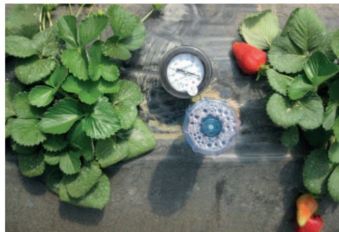
I volumi degli adacquamenti sono definiti al litro in seguito ai monitoraggi dell'umidità del terreno tramite sonde TDR, mentre il turno irriguo è stabilito in base alla lettura dei tensiometri.
