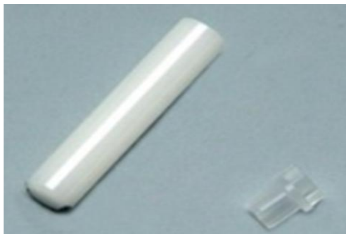
Figura 19. Rotore in zirconia da 4mm ( \varnothing_{int.} ) accoppiato a tappo in Kel-F® con alette.
