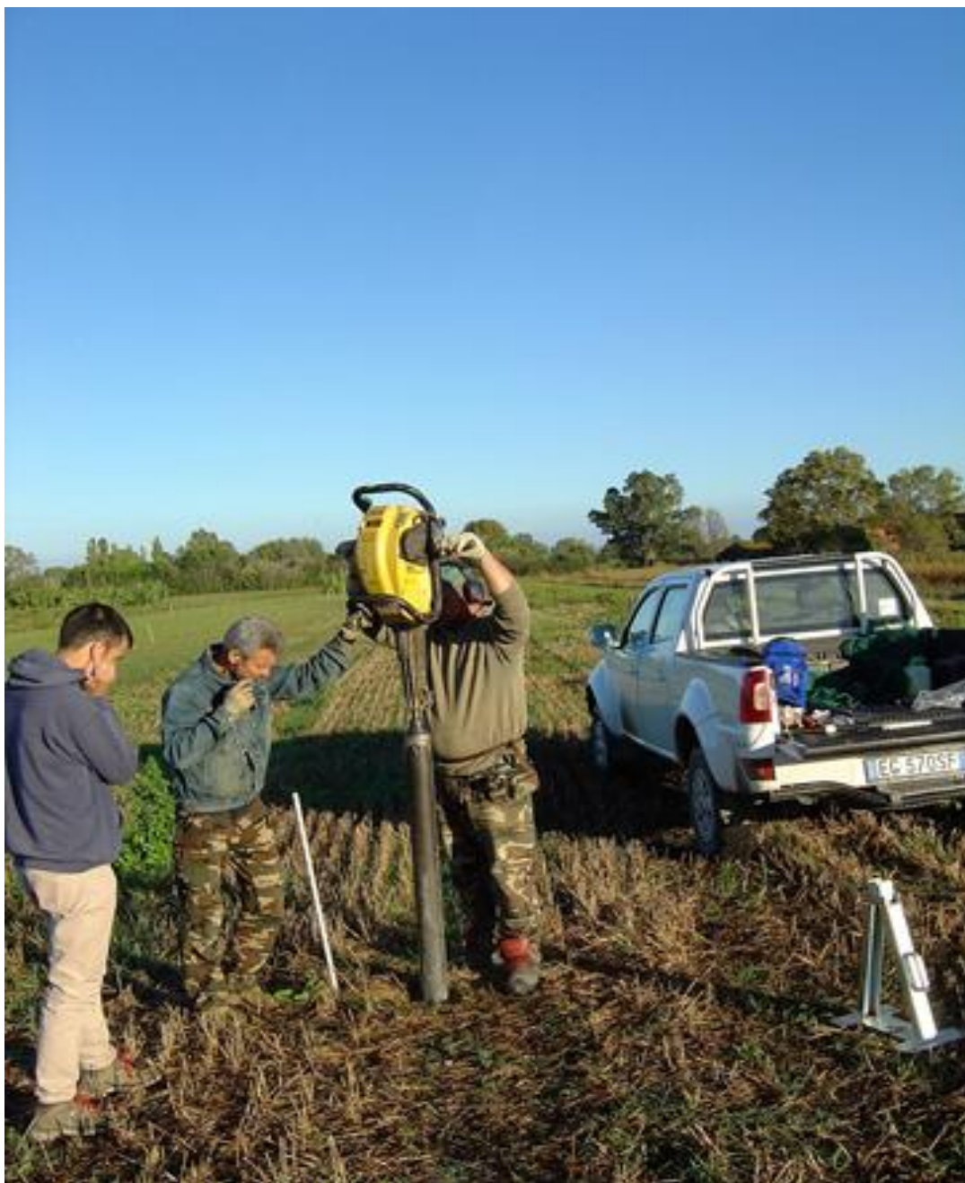
Figura 7 – Campionamento di un profilo indisturbato di suolo fino a 100 cm di profondità per determinare l'effetto della gestione organico-biologica sulla fertilità dei diversi strati di terreno in collaborazione con la OHIO STATE UNIVERSITY di Columbus, USA
