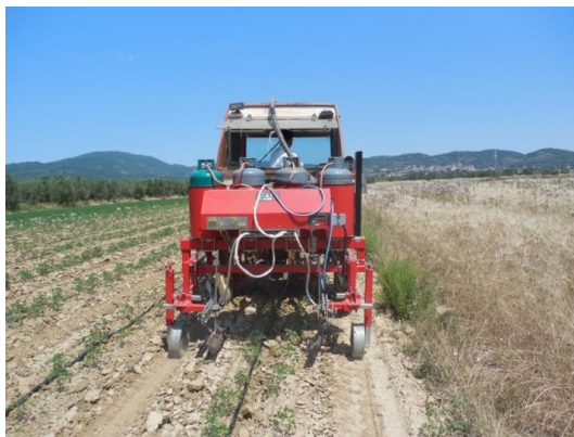
Fig. 20 - Operatrice per il pirodiserbo a fiamma libera allestita per il trattamento di "side flaming" in fase di lavoro su alcune parcelle in cui è stato adottato l'itinerario tecnico innovativo 2.
