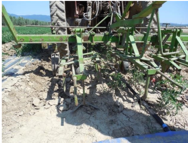
Fig. 18 - Particolare degli utensili di cui era equipaggiata la sarchiatrice di precisione durante il secondo intervento effettuato nell'ambito dell'itinerario tecnico innovativo.
