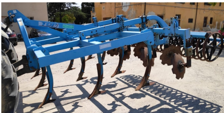
Fig. 39 – coltivatore combinato utilizzato per la lavorazione principale del terreno.
