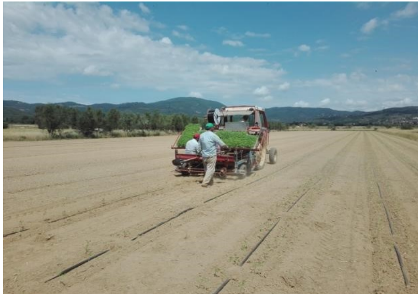
Fig. 16 – Trapianto del pomodoro con contemporanea stesura della manichetta per l'irrigazione nell'itinerario tecnico innovativo.
