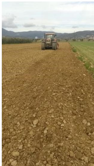
Fig. 12 – Semina della cover crop con seminatrice meccanica associata a erpice rotante nell'itinerario tecnico innovativo.
