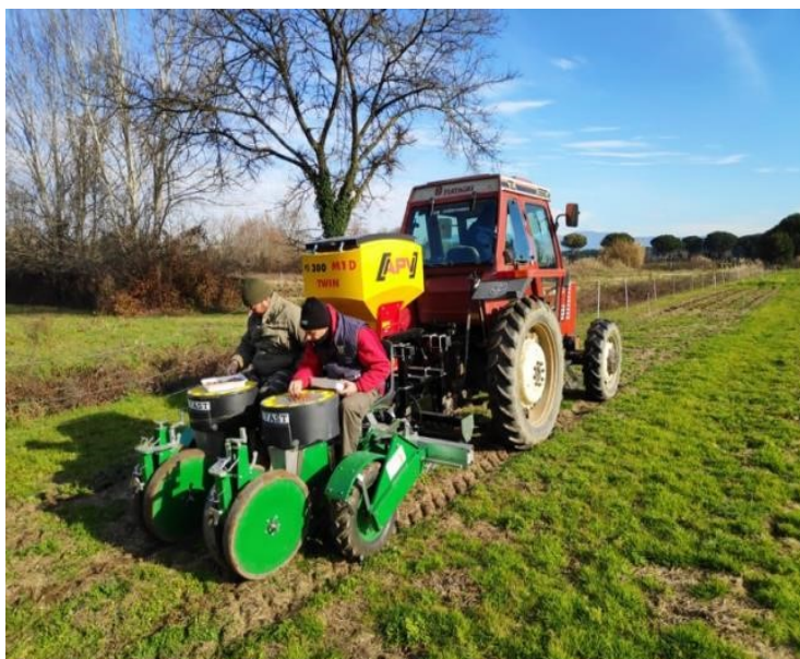
Fig. 52 – Macchina per il trapianto diretto degli ortaggi, equipaggiata con tramoggia per l'applicazione intra-solco di fertilizzanti.
