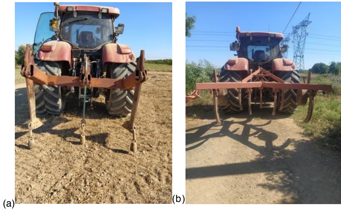
Fig. 7 – “Subsoiler” a tre ancore diritte dotate di ogiva (a) e coltivatore pesante “chisel” a sette ancore ricurve (b) utilizzati per la lavorazione profonda del terreno nell’itinerario tecnico aziendale.
