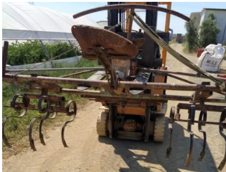
Fig. 10 – Sarchiatrice "artigianale" realizzata in azienda per la lavorazione con controllo meccanico delle infestanti nello spazio tra le bine nell'itinerario tecnico aziendale.
