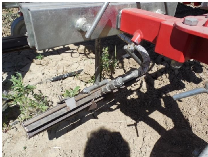
Fig. 21 - Particolare del bruciatore prismatico dell'operatrice per il pirodiserbo a fiamma libera per il controllo termico selettivo delle infestanti presenti sulle due file che compongono la bina.
