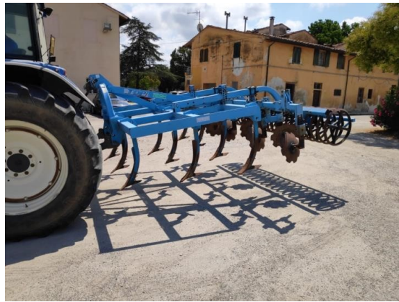
Fig. 11 – Coltivatore combinato utilizzato per la lavorazione ridotta del terreno e per l'interramento della cover crop nell'itinerario tecnico innovativo.
