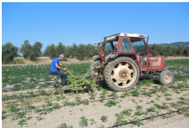
Fig. 17 - Sarchiatrice di precisione in fase di lavoro durante la prima sarchiatura prevista dall'itinerario tecnico innovativo.
