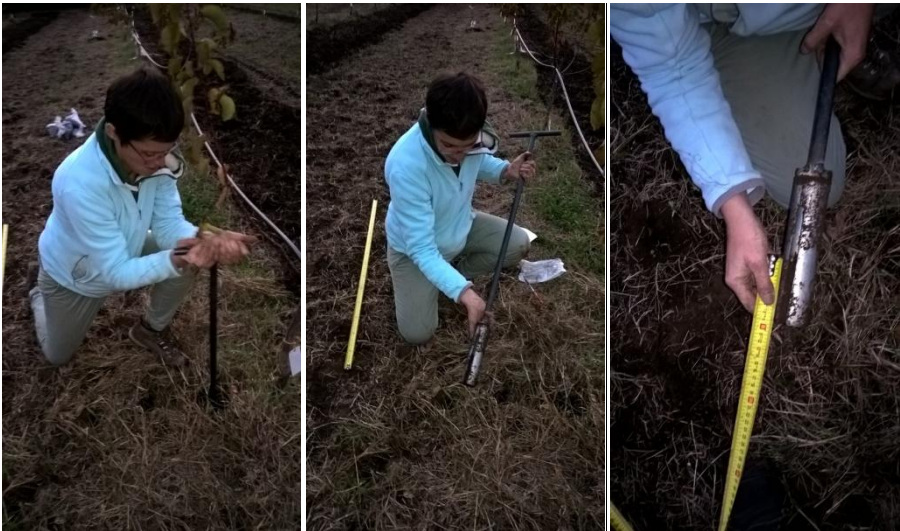
Figura 27. Carotaggi per il prelievo campioni
