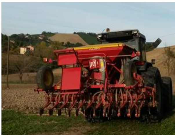
Figura 17. Seminatrice pneumatica utilizzata per l'inerbimento "controllato".
