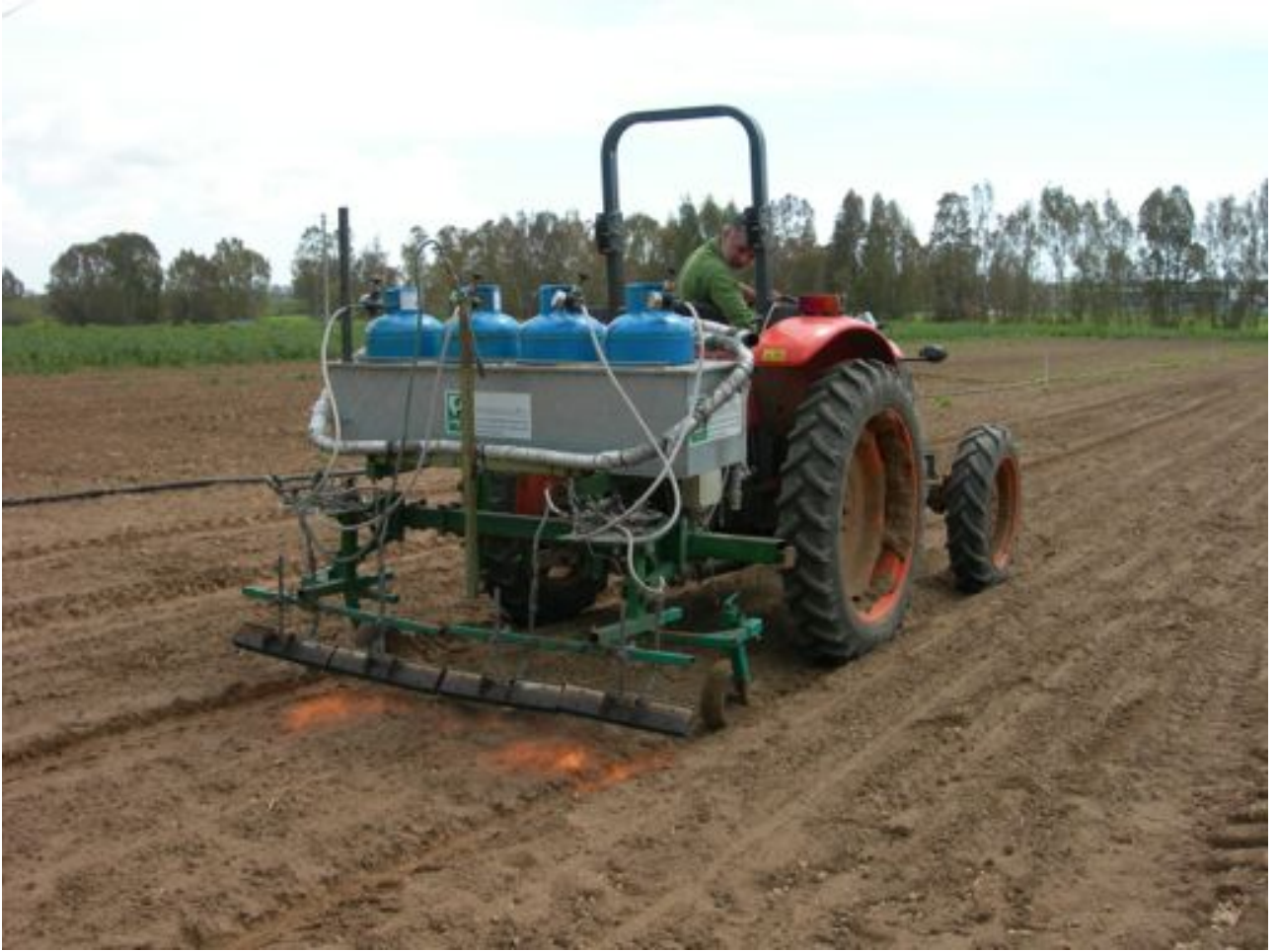
Fig. 11. Trattamento di pirodiserbo presso l'Azienda Caramadre
