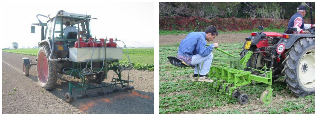
Figura 6. Operatrice per il pirodiserbo (a sinistra) e sarchiatrice di precisione (a destra).
