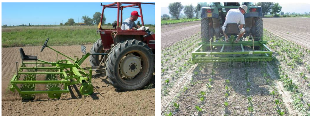
Figura 5. Erpice a dischi attivi conformato per la realizzazione della falsa semina (a sinistra) e per la sarchiatura di precisione (a destra).
