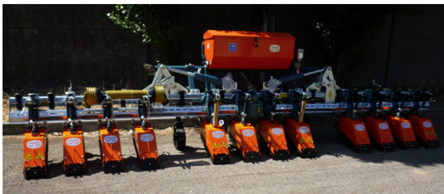
Figura 8. Sarchiatrice equipaggiata con utensili azionati su asse orizzontale ("multifresa"), utilizzata in combinazione con la macchina trainata "T1200" della ditta Celli per la realizzazione del "band steaming".
