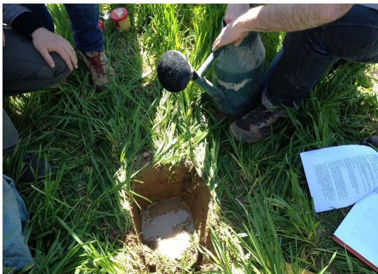
Figura 7.2: La soluzione di senape viene versata nel foro e viene misurata l'infiltrazione. Foto: D. Antichi
