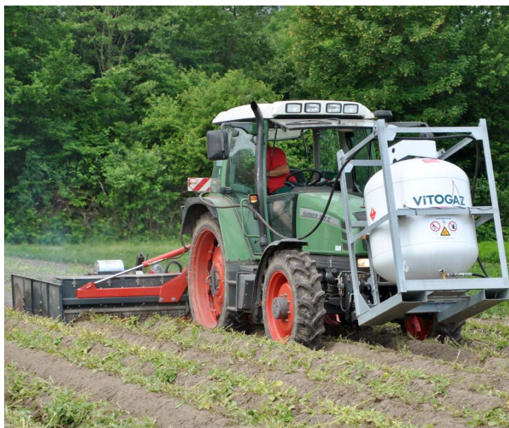
Désherbeur thermique moderne muni d'une citerne fixée à l'avant du tracteur
